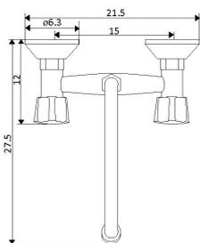
**MISTURADORA BANCA PAREDE 75N**
